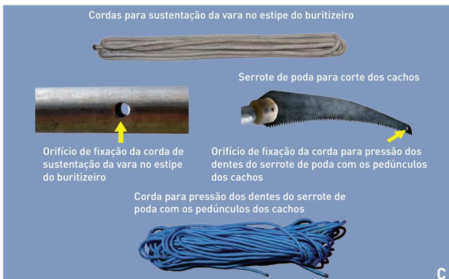
**FIGURA 7.** (A) Tubos de alumínio naval que formam a vara de coleta, (B) Detalhe dos tubos de 3,12cm de diâmetro por 0,30cm de espessura com roscas de 10 fios internos e dos tubos de 2,46cm de diâmetro por 0,26cm de espessura com roscas 10 fios a partir de 10cm das extremidades externas, (C) Detalhes das ferramentas e acessórios para o corte dos cachos de buriti.
